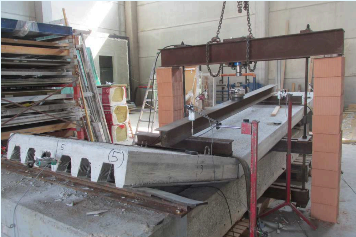
Fotografia del provino di solaio dopo il collasso.
