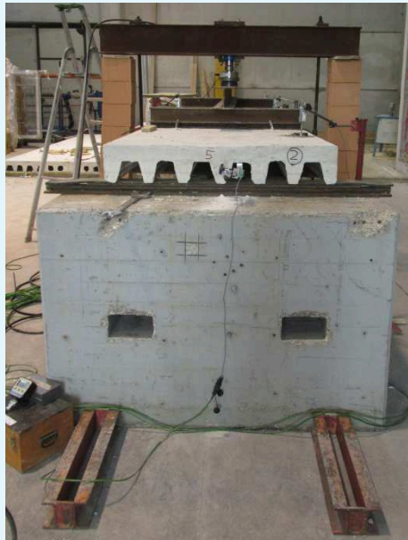
Fotografia di particolari di un provino di solaio: testata, appoggio e linea di carico.
