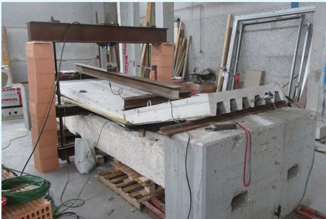
Fotografia della rottura del provino di solaio dopo il collasso.
