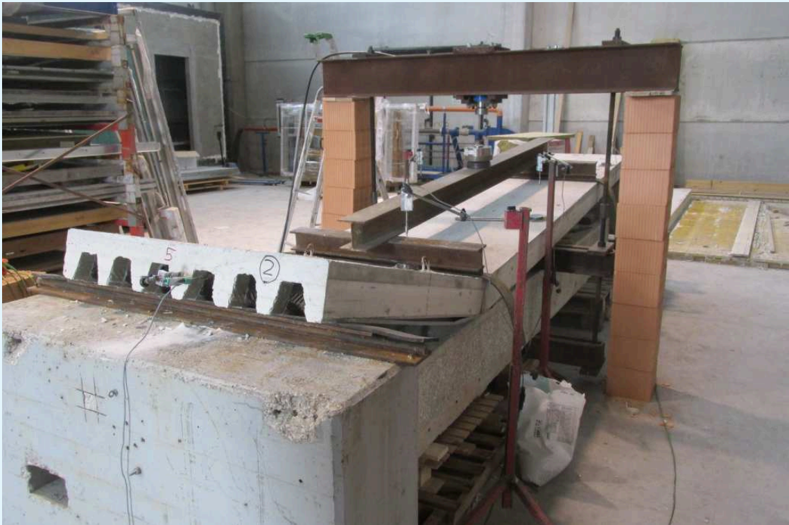
Fotografia della rottura del provino di solaio dopo il momento del collasso.
