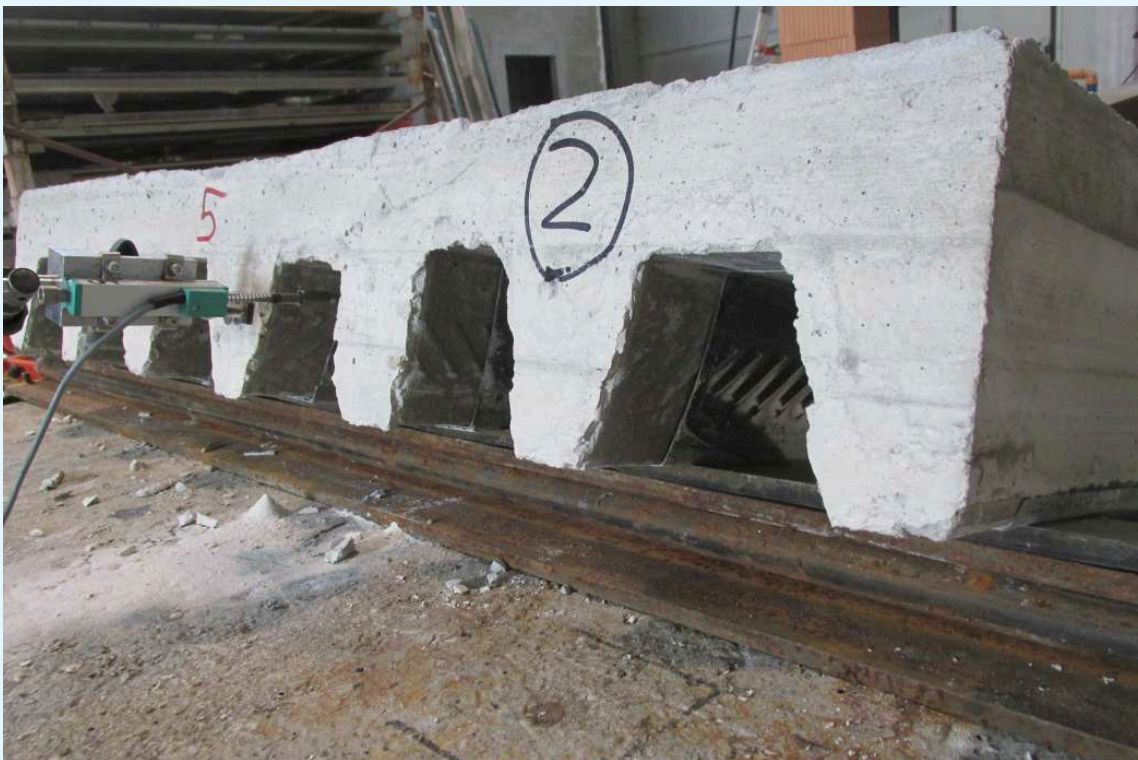
Fotografia del trasduttore laterale per la lettura dello scorrimento.
